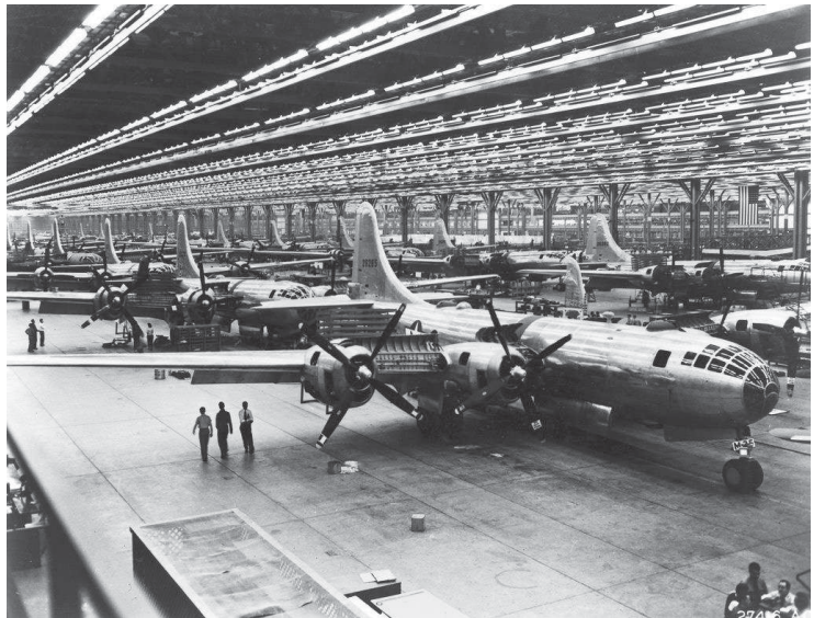
Il flusso della produzione: catena di montaggio di B-29 nel 1944. (USAFHRA)
