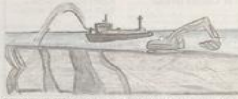
RIPIASCIMENTO Una draga per il prelievo e il trasporto delle sabbie
